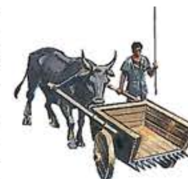
Жатка для уборки зерновых. Реконструкция.
